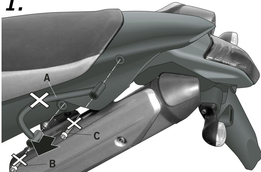
(E) Desmontar y desestimar los agarraderos laterales (A) mediante los tornillos delanteros (B) y los traseros (C); éstos a su vez se desestiman.
