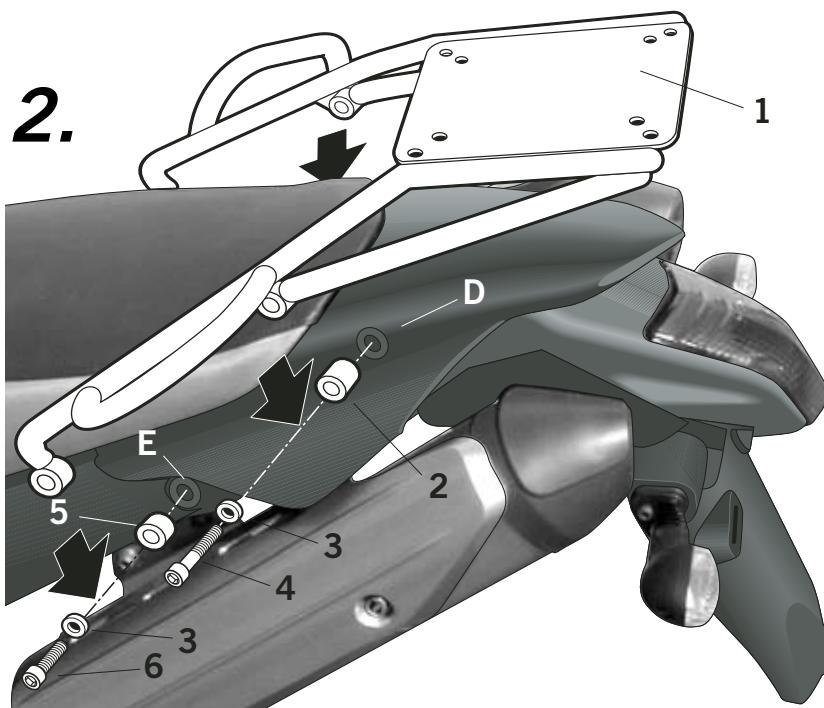
(E) Posicionar el soporte KIT TOP PARRILLA (1) en zona trasera (D), mediante los distanciadores (2), las arandelas (3) y los tornillos (4).
